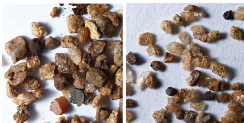
Figur 11. Två sedimentprover från provpunkt B2. Det vänstra provet motsvarar kornstorlekar mellan 2 till 0,85 mm och det högre provet utgör 0,25 till 0,6 mm.
