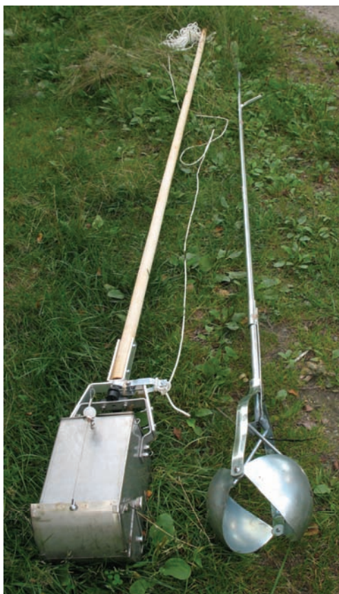
Figur 1. Använda sedimentprovtagare. Ekmanhuggare fastsatt på skaft till vänster och slamtömmare till höger. Den högra typen rekommenderas vid framtida liknande inventeringar i vattendrag.
